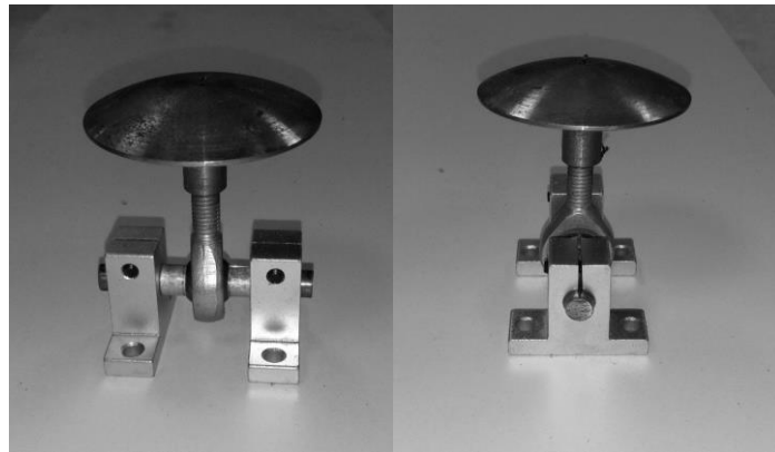
Figura 1: Dispositivo de aislación sísmica propuesto Esc. (1:25).
