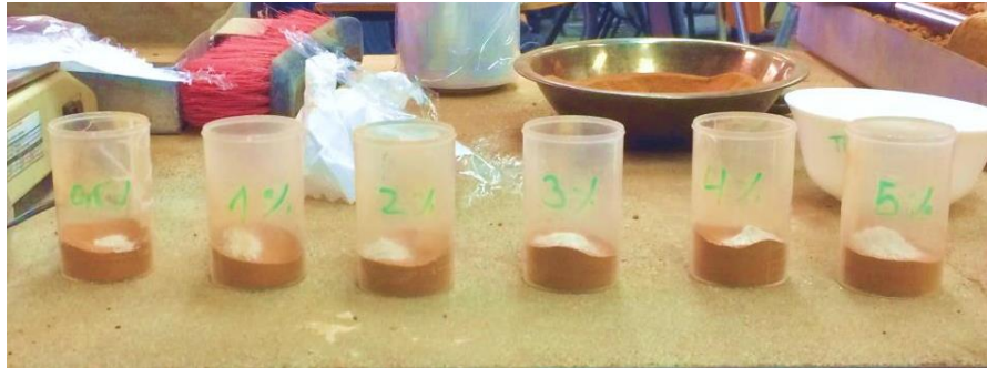
Figura 3.4: Muestras de suelo y cal (con variados porcentajes) a ensayar, antes de introducir agua común.
