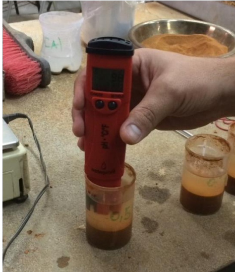
Figura 3.6: Medición de pH y temperatura de las mezclas suelo-cal. Fuente: Elaboración propia.
