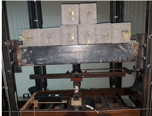
Figura 12: Losa de mesa vibradora y bloques de hormigón que proporcionan la carga axial.
