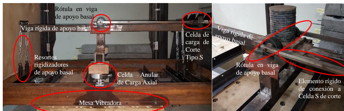
Figura 5: Soporte rotulado en dirección de análisis o marco de carga.
