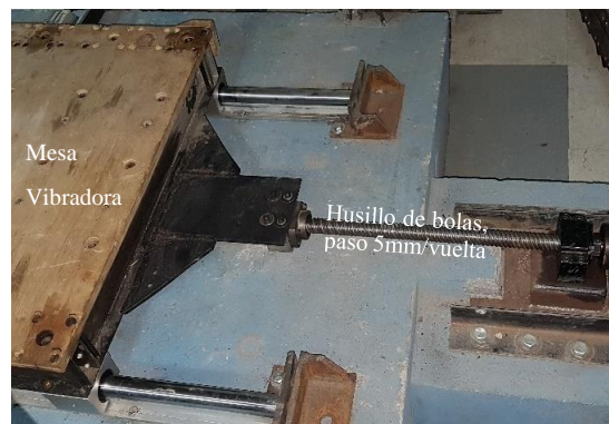
Figura 8: Husillo de mesa vibradora que permite el desplazamiento horizontal a razón de 5mm/vuelta.
