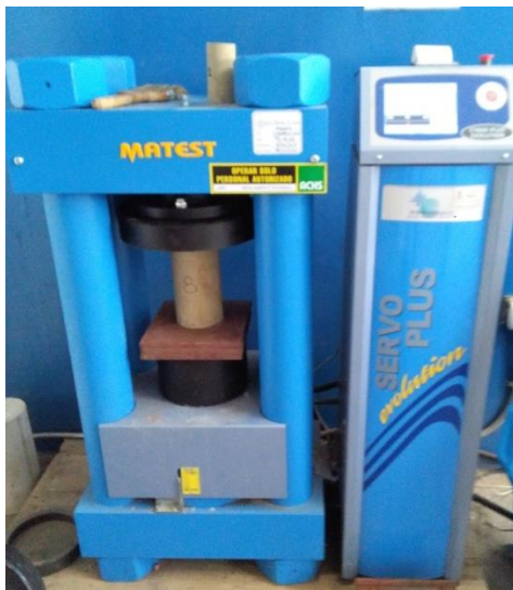
Figura 12: Ensayo de probeta de 100 mm de diámetro efectuado en máquina Matest
