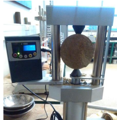
Figura 15: Ensayo carga puntual efectuado sobre probeta de 100 mm de diámetro.
