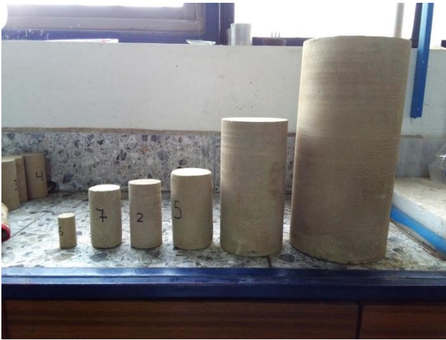
Figura 10: Probetas cilíndricas de varios diámetros: 25, 50, 60, 100 y 150 mm.
