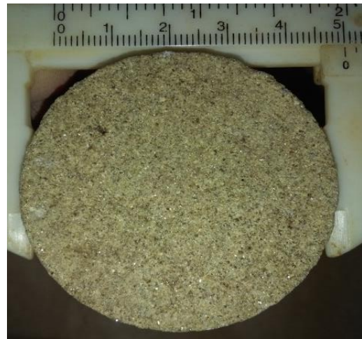
Figura 11: Probeta cilíndrica de 50 mm de diámetro.
