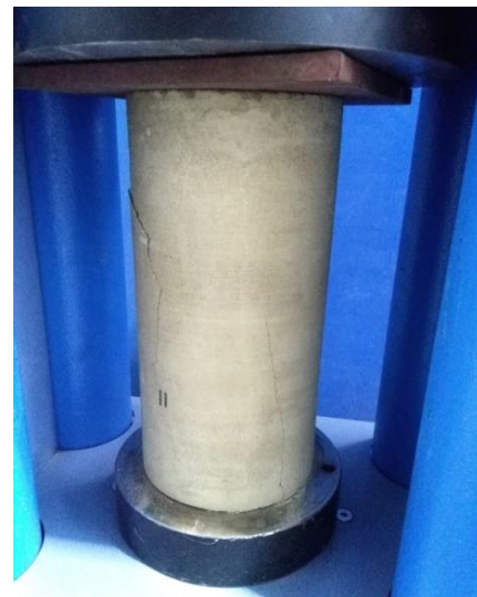
Figura 13: Ensayo de probeta de 150 mm de diámetro efectuado en máquina Matest
