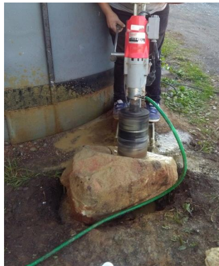
Figura 8: Resondeo mediante testiguera de bloque de arenisca en el laboratorio para obtener probetas cilíndricas de 150 mm de diámetro.
