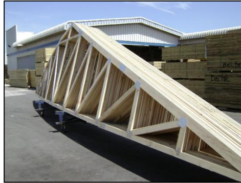
Figura 14. Cercha Madera.- Fuente: Tecno Panel.
