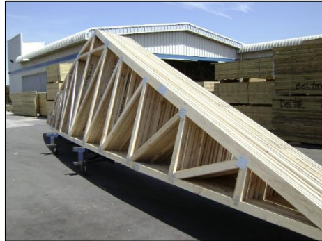
Figura 11. Cercha Madera.- Fuente: Tecno Panel.
