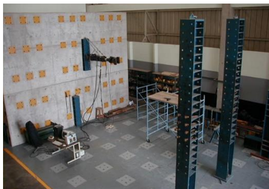
Figura 2.10: Losa y Muro De Reacción – Universidad de Costa Rica.
