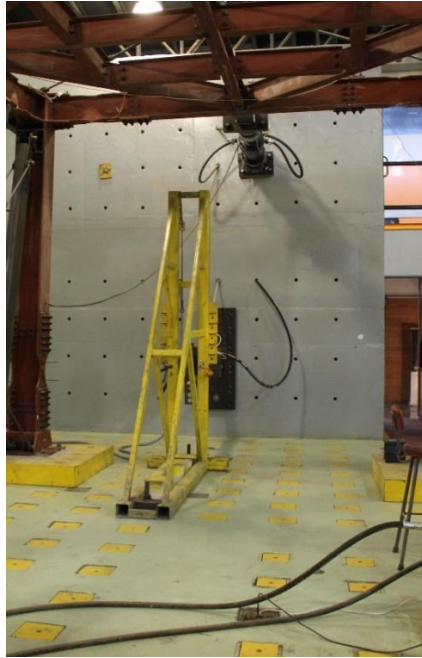
Figura 2.1: Muro y Losa de Reacción - Pontificia Universidad Católica de Chile.
