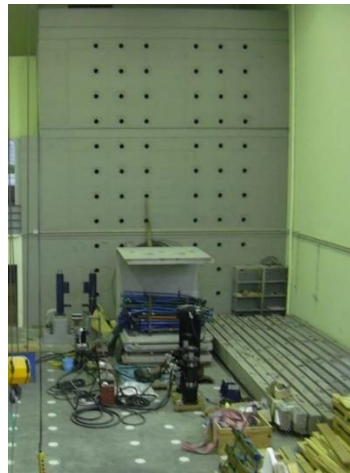
Figura 2.6: Losa y Muro de Reacción – Universidad de la Coruña.
