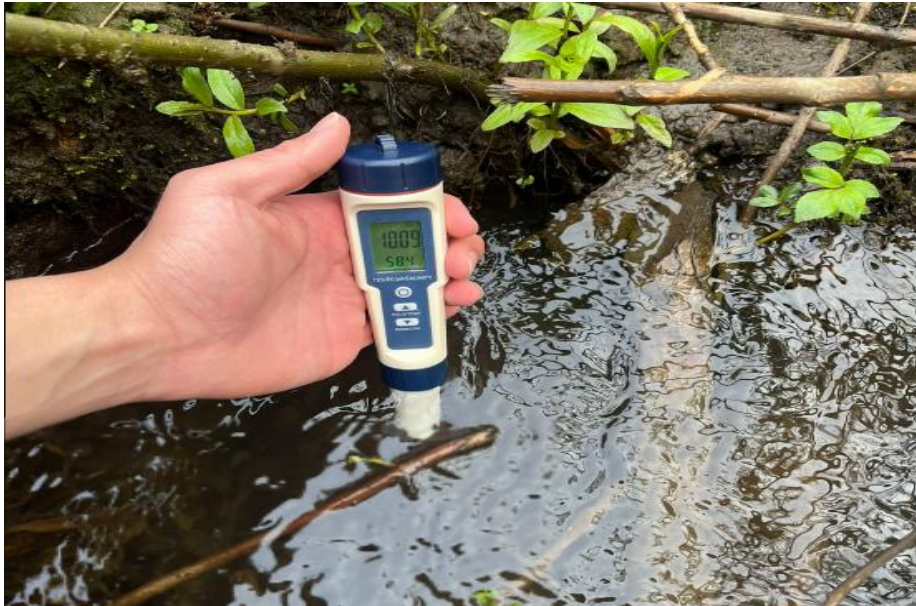
Anexo D 2. Toma de muestras de calidad agua para los parámetros de pH y temperatura.
