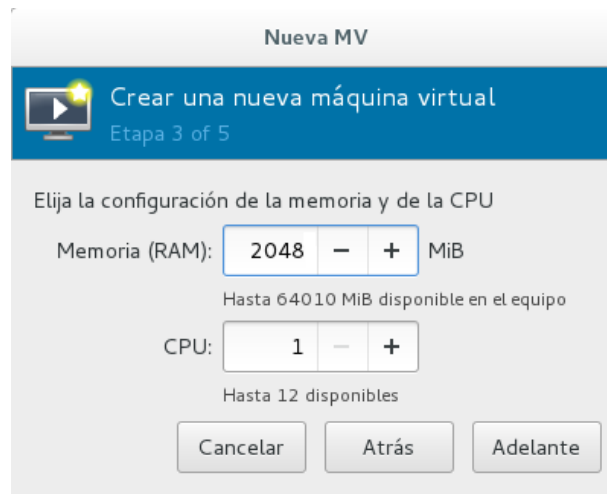
Figura 4.66: Asignación de memoria RAM y cantidad CPUs virtuales con virt-manager (Fuente Propia).
