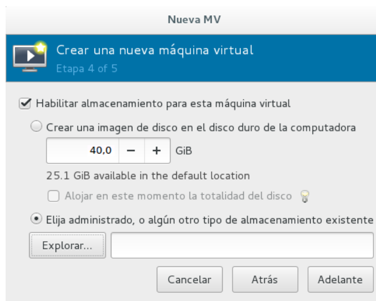
Figura 4.67: Asignar espacio de almacenamiento con virt-manager (Fuente Propia).
