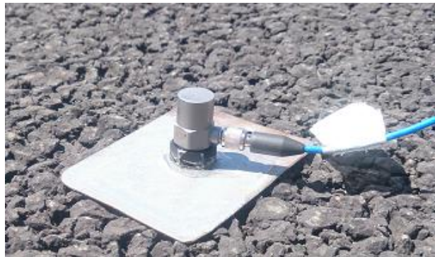
Figura 3.9: Mediciones de aceleraciones verticales puente Bicentenario.
