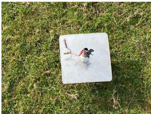
Fig. 5.3. Vista aérea de la antena monopolo.
