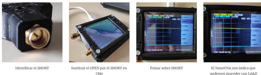
Fig A.2. Calibración del NanoVNA en circuito Cerrado. Fuente: [10]
