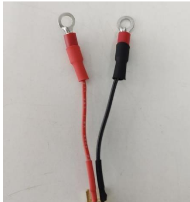
Fig. 3.5. Cable de transmisión utilizado entre la antena monopolo y el conector SMA
