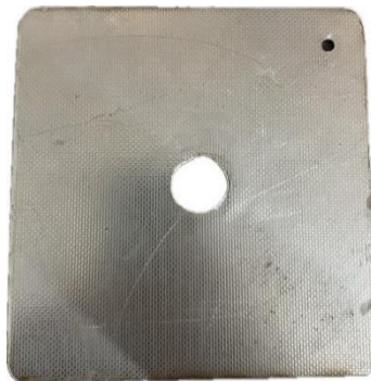
Fig. 3.3. Plano de tierra de antena Monopolo (plancha de aluminio)
