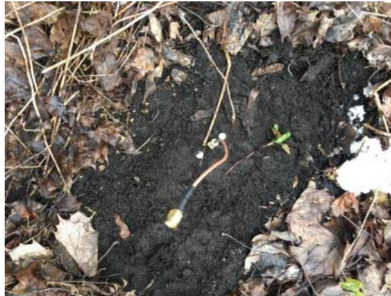
Fig. 2.16. Antena Dipolo enterrada en el suelo para realizar medición. Fuente: [12]
