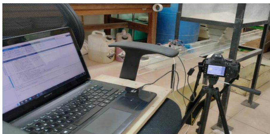
Fig. 5-4. Montaje de sistema de captura de imágenes en pruebas de adocreto.
