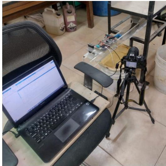
Fig. 4-4. Montaje de sistema de procesamiento de imágenes en adocreto.
