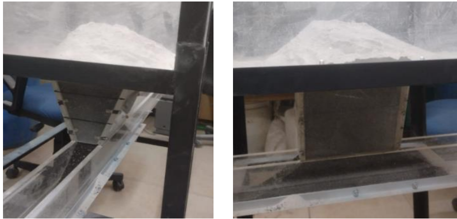
Fig. 4-1. Disposición del material fino sobre el grueso.
