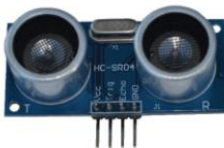
Fig. 2-6. Sensor ultrasónico HC-SR04 [10].
