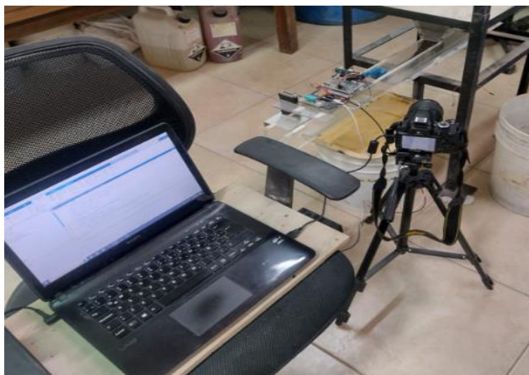
Fig. 5-16: Montaje de sistema de captura de imágenes en arena.
