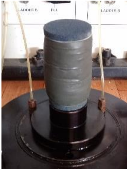
Figura 4.12: Probeta terminado el ensayo Triaxial UU.
