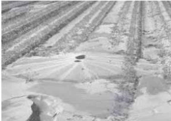
Figura 2.29: Ebullición de arena en campos de arroz después del terremoto de Niigata de 1964 (Kramer, 1996)
