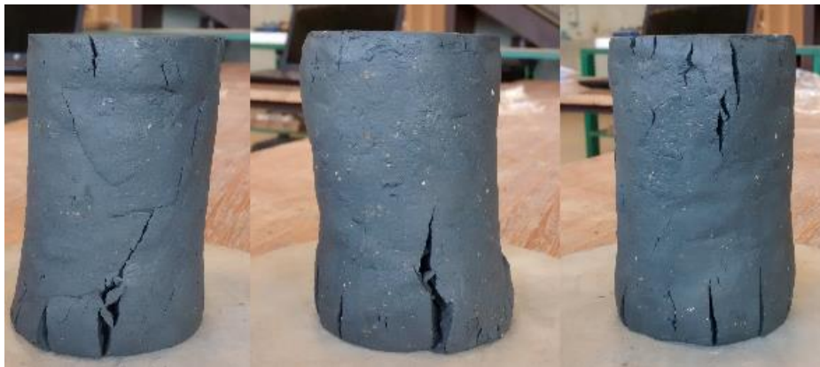
Figura 4.9: Probeta finalizado el ensayo CNC en suelos cohesivos.
