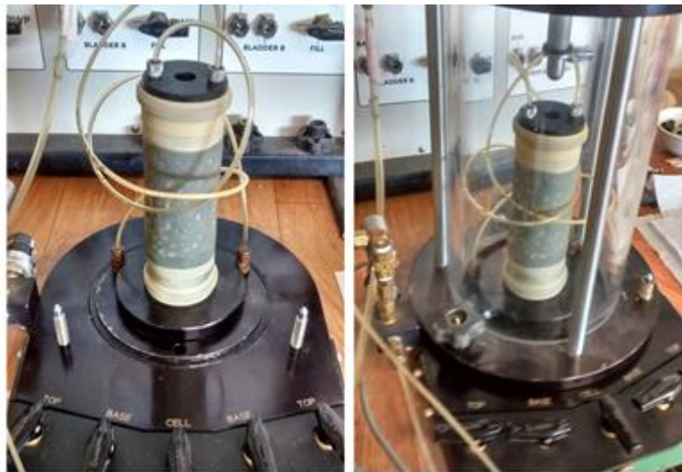
Figura 3.7: Probeta en Cámara Triaxial, antes del ensayo UU (elaboración propia).
