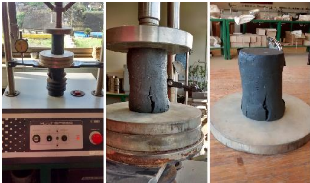
Figura 3.6: Probeta de suelo antes, durante y después del ensayo CNC (elaboración propia).
