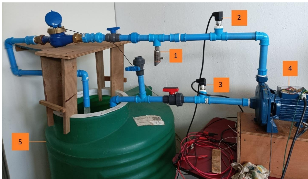
Fig. 2-1. Set up montado en el Laboratorio de la UCSC (1. Sensor de caudal; 2. Sensor de Presión de impulsión de agua; 3. Sensor de Presión de succión de agua; 4. Bomba de agua trifásica; 5. Estanque de agua).
