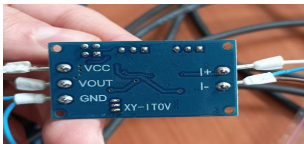
Fig. 3-8. Módulo convertidor de señales 4 a 20 mA a voltaje.
