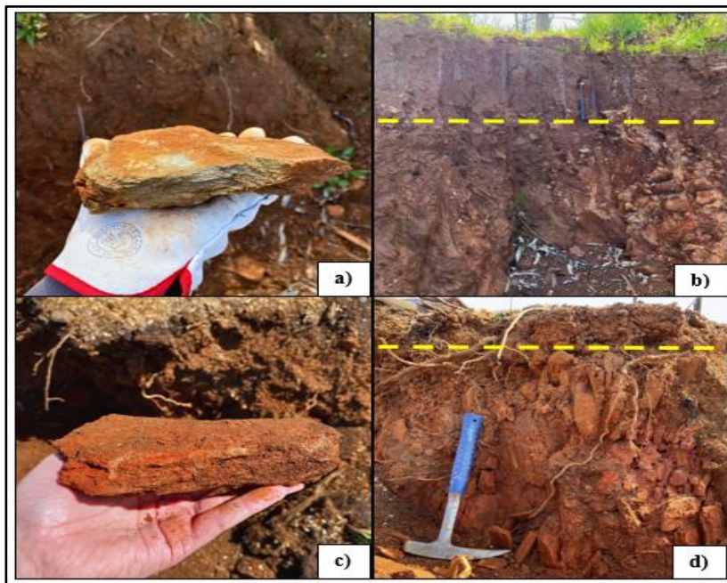
Figura 8: a) Roca metamórfica en un grado II de meteorización. b) Horizonte de suelo de 60 cm. c) Roca metamórfica en un grado IV de meteorización. d) Horizonte de suelo de 7 cm. (Elaboración propia).
