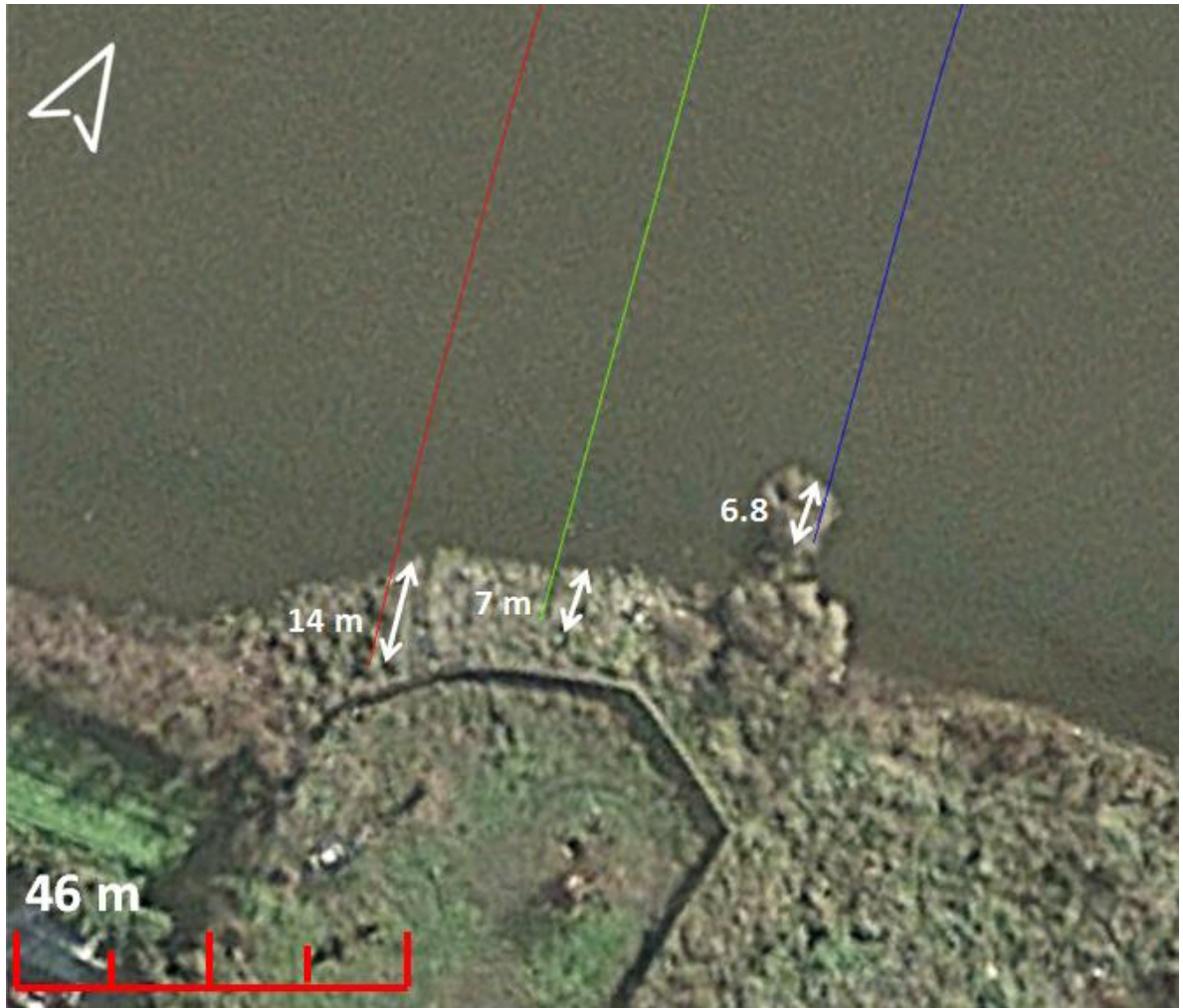
Figura 3.9: Resultado de la modelación del borde del espejo de agua en el perfil del punto 1 en la ribera sur (rojo malla 4 x 12 m, verde malla 12 x 30 m y azul malla 35 x 90 m).
