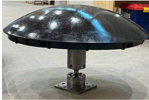
Figura 2. Dispositivo de aislamiento utilizado para los ensayos.
