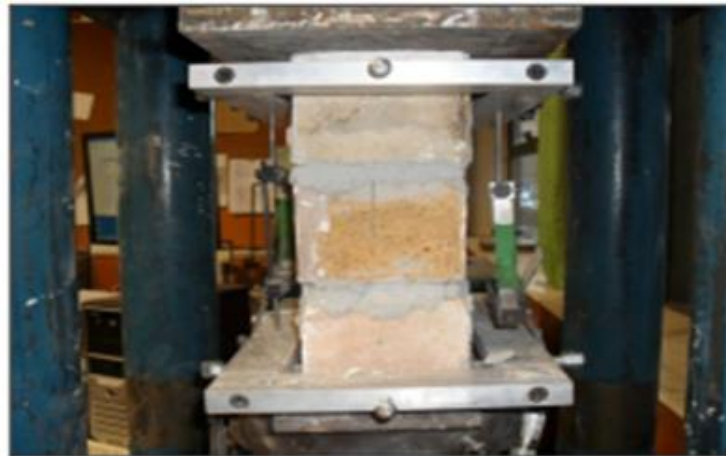
Figura 2. 4: Ensayo de compresión de prisma de albañilería. [10]
