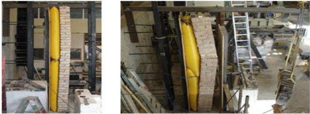
Figura 2.12: Simulación de la fuerza sísmica a través de bolsas de aire. [14]
