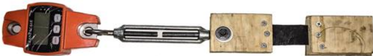
Figura 4: Instrumento para realización del ensayo tracción-rotura
