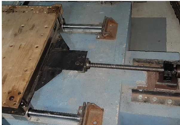
Figura 15: Husillo de bola para mover la mesa vibradora
