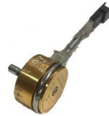
Figura 11: Sensor de giro
