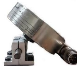
Figura 13: Condición de apoyo del sensor anular
