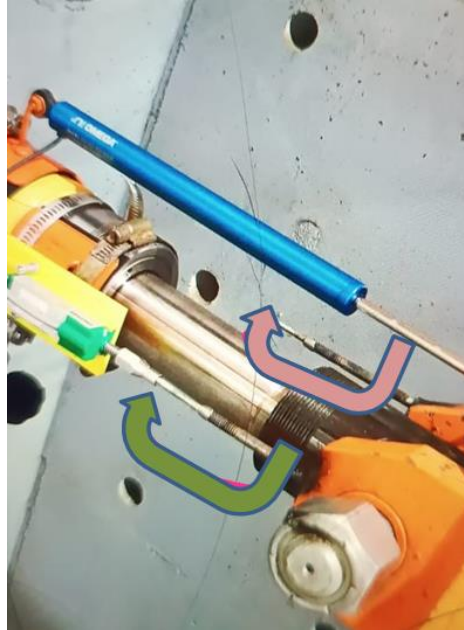
Figura 12: LVIT Omega y LVDT ktr instalados sobre el actuador (Fuente: Elaboración propia).
