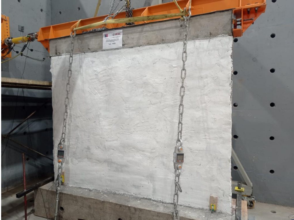
Figura 11: Muro de albañilería simple reforzado con malla electrosoldada montado para ensayo con aparejo de carga (Fuente: Elaboración propia).
