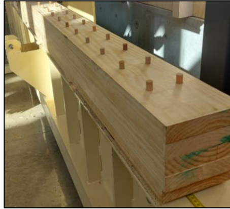
Imagen n°3: Ensamblaje de vigas a ensayar DLT Fuente: Elaboración propia
