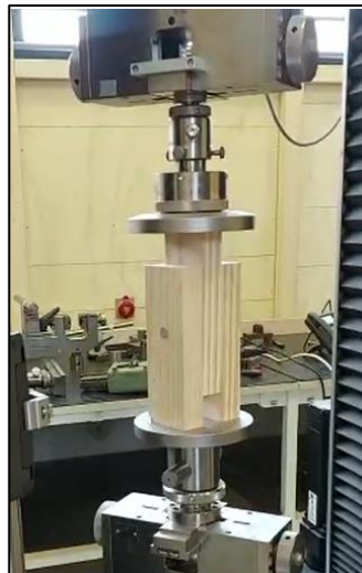
Imagen n°13: Montaje de probeta de tarugos simple Fuente: Elaboración propia
