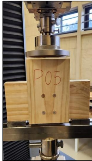
Imagen n°15: Montaje de probeta de tarugos cuádruple Fuente: Elaboración propia
