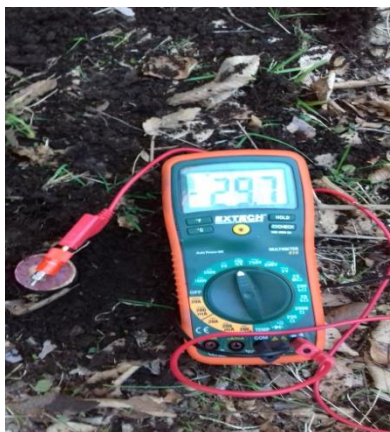
Figura 8: Medición de Potencial Espontáneo en terreno.
