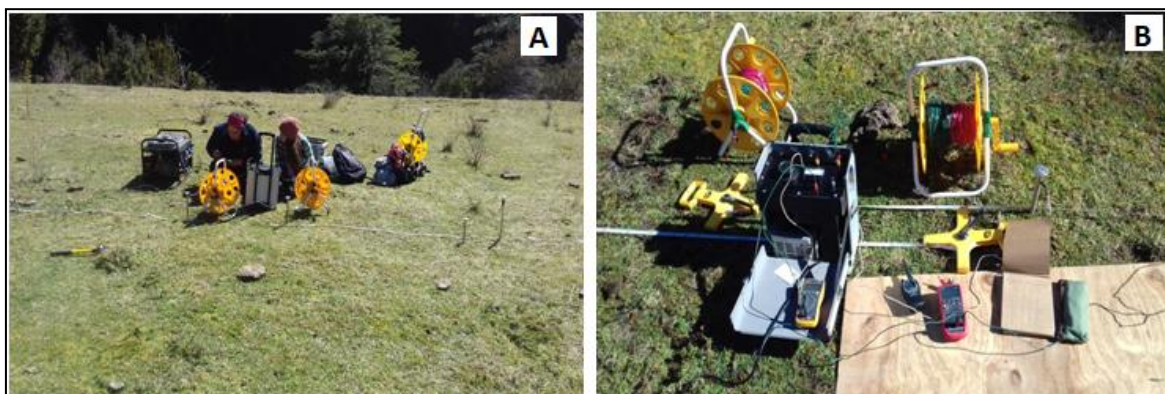
Figura 11: En el recuadro A ejecución y medición de SEV, en el recuadro B, el equipo utilizado para la medición.
