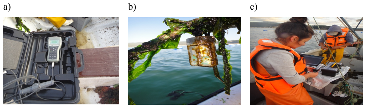
Fig. 13. Equipos en terreno a) Equipo multiparámetro Instruments modelo HI 9829, b) Dispositivo Hobbo, c) Extracción datos desde dispositivos Hobbo in situ . Fuente: Archivo Personal.
