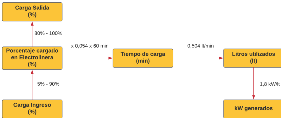
Fig 5.1 Diagrama de flujo de un proceso de carga.
