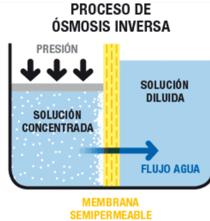
Figura 2. Proceso de osmosis inversa.
