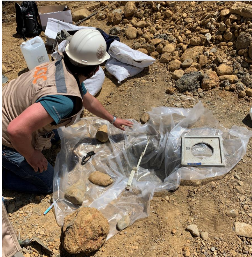
Figura 6.- Determinación de densidad in-situ a través de medición de volumen de suelo retirado (Elaboración propia, 2022).
