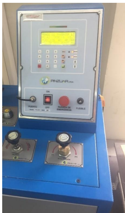
Figura 16. Centro de control PC-42-D para ensayos RILEM.
