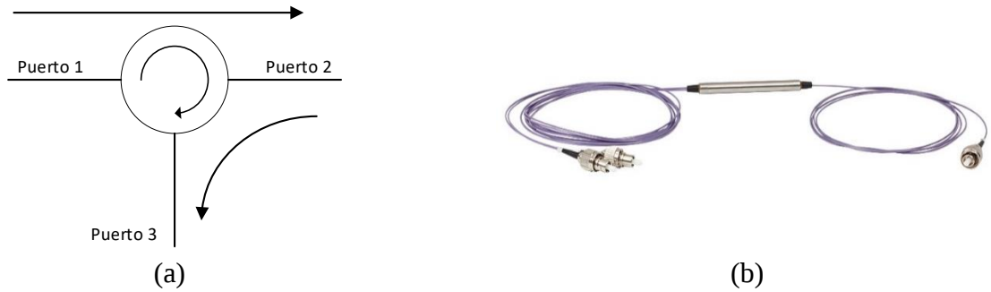
Figura 2.16 Circulador. (a) Diagrama de un circulador. (b) Circulador Thorlabs 6015-3-FC. Fuente: https://www.thorlabs.com/thorproduct.cfm?partnumber=6015-3-FC
