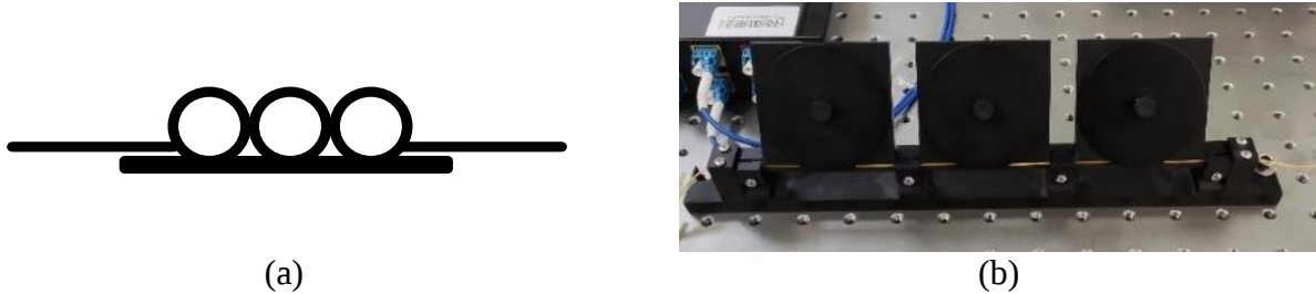
Figura 2.12 Polarizador Manual. (a) Diagrama Polarizador Manual. (b) Polarizador Thorlabs FPC560.
