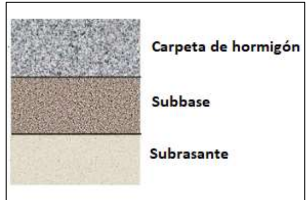
Figura 5. Estructura de Pavimento Rígido. Elaboración propia.
