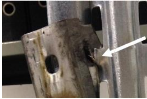
Figura 12: Efecto de punzonamiento en la columna Fuente: [3]
