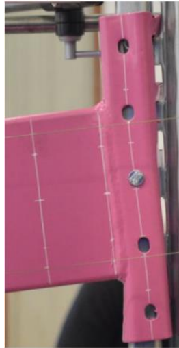
Figura 8: Conector en flexión observado durante las pruebas. Fuente: [3]
