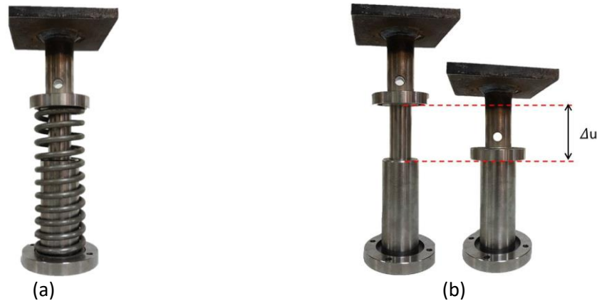
Figura 6: Elemento Elástico: (a) Resorte con mecanismo anti pandeo. (b) Límite de deformación permitida, u_{MP} .
