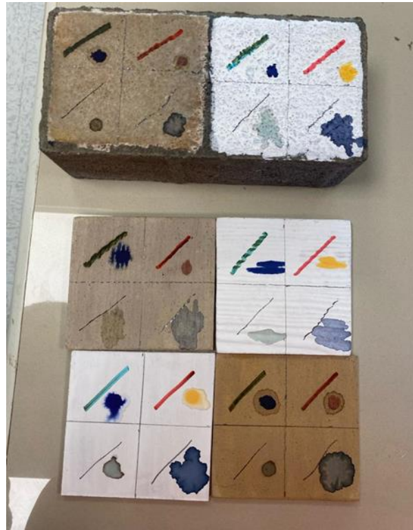
Figura E: Probetas finalizando el sometimiento a periodos de luz fría. Fuente: Elaboración propia
