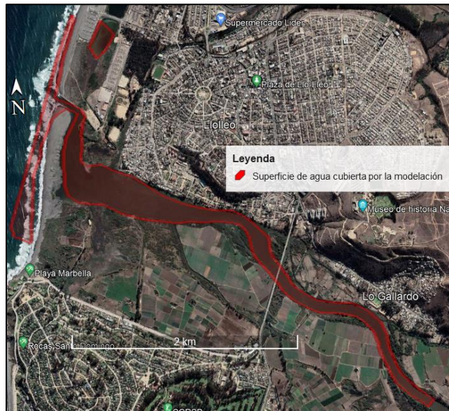
Figura 10 Superposición del nivel de agua modelado por el software en imagen satelital, agosto 2021. Fuente propia.
