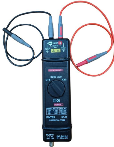
Fig. 6.8 Sensor de Voltaje PINTeK DP-25.
