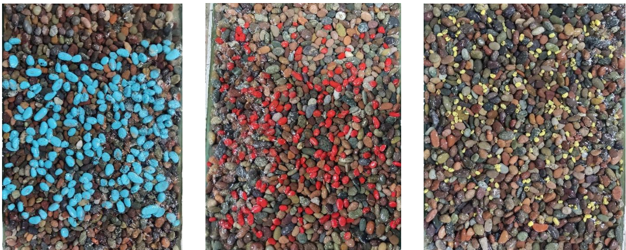
Figura 1: Escenarios experimentales corresponden al lecho base D_1 con partículas móviles D_2 , D_3 y D_4 , respectivamente.
