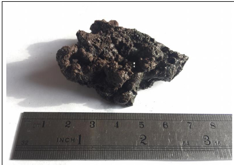
Figura 6. Textura porosa de escoria de carbón estudiada.
