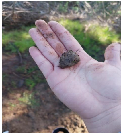
Figura 9: Muestra de suelo con evidencia de alta plasticidad.
