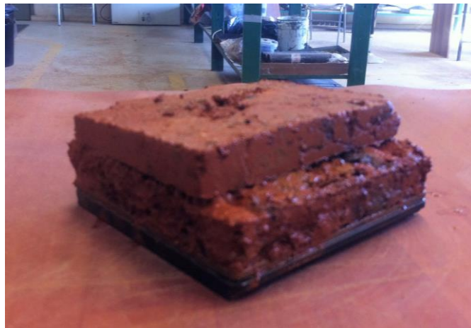
Figura 3.7: Probeta inalterada, después de la fase de corte. (Fuente: Elaboración propia).
