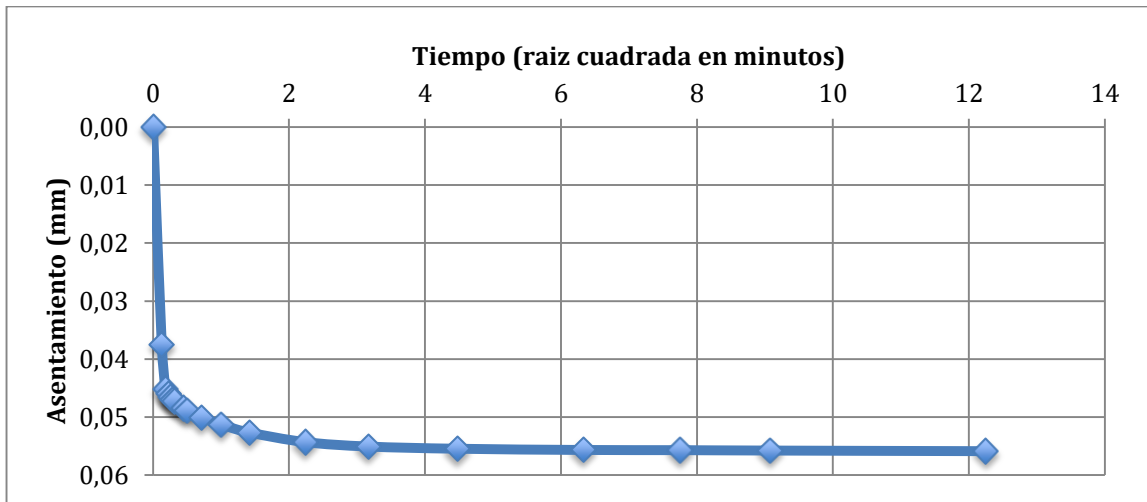
Figura 7.14: Consolidación de muestra M2 a una tensión de 50 kPa. (Fuente: Elaboración Propia).
