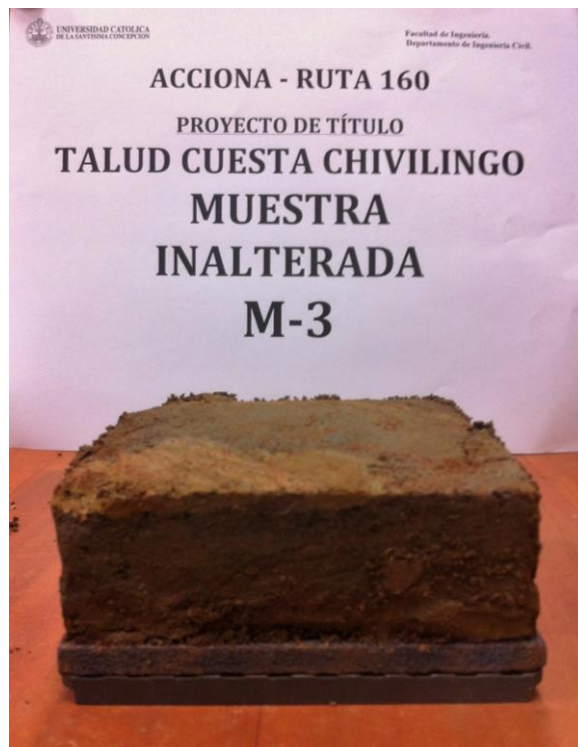
Figura 3.6: Muestra inalterada tallada para realizar ensayo de corte directo. (Fuente: Elaboración propia).
