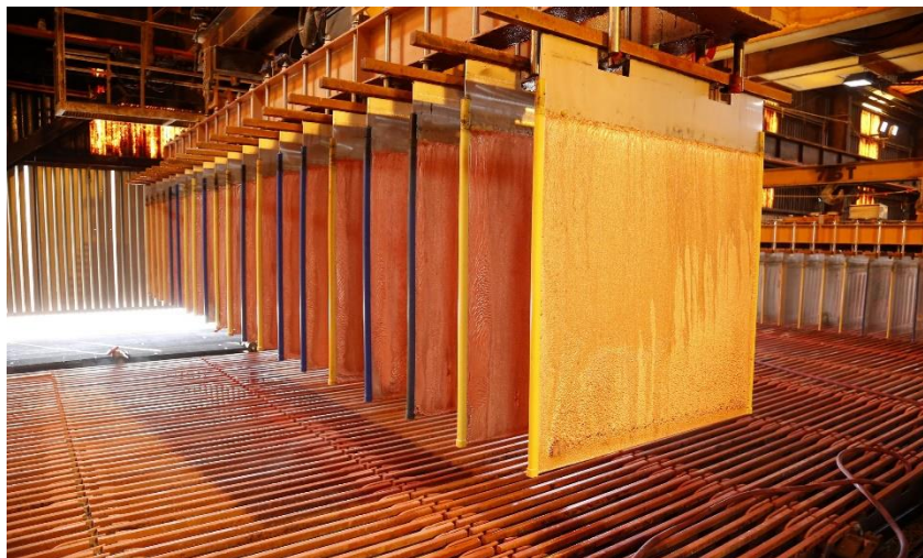
Fig. 2-1: Cosecha de cátodos de Cobre
