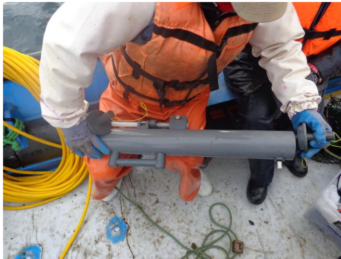
Fig. 12. Equipos utilizado para obtención de datos de variables ambientales: a) Multiparámetro Hanna, modelo HI 9828, b) Fluorómetro Turner Designs Aquafluor y c) Botella de Niskin de 3 L.
