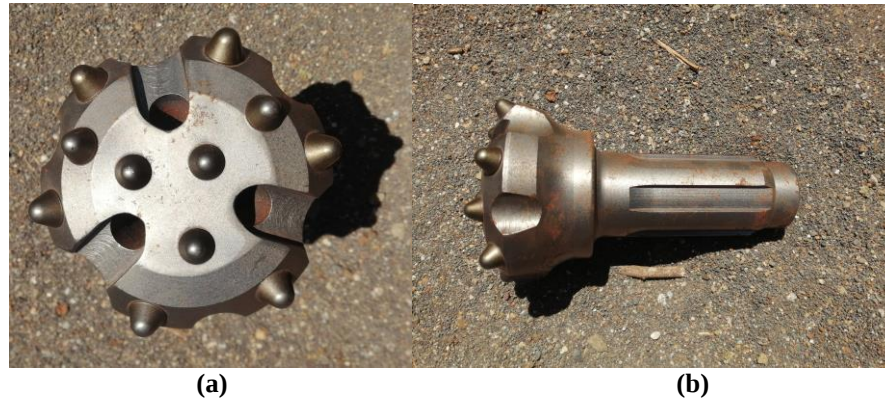
Figura 2.14 Broca utilizada en Sistema DTH.
