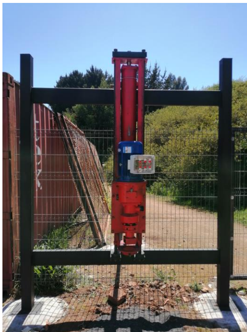
Figura 2.4 Perforadora DTH montada en estructura.
