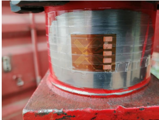
Figura A.2 Strain gauge adherida en superficie de perforadora DTH.
