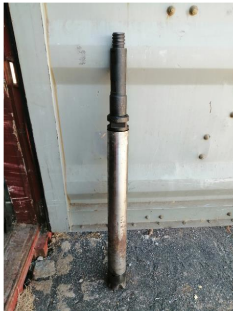
Figura 2.11 Martillo DTH utilizado.
