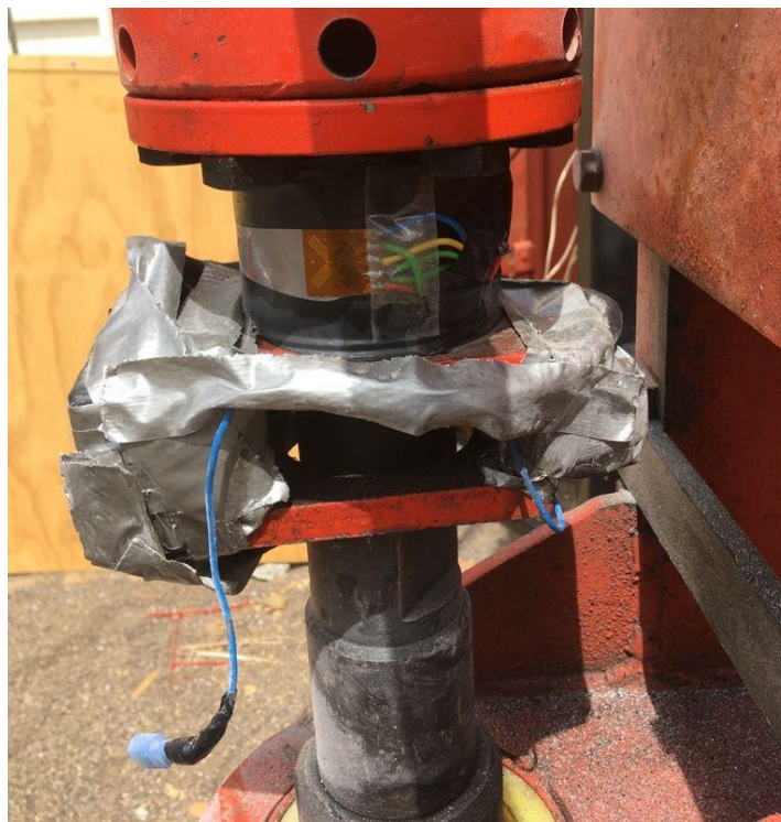
Figura A.7 Montaje final Strain gauge y SG-LINK-200.
