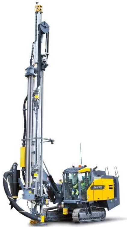
Figura 1.4 Perforadora DTH SmartROC D65 de Atlas Copco.
