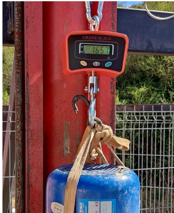
Figura 4.6 Medición peso de la perforadora para cálculo de fuerza de empuje.
