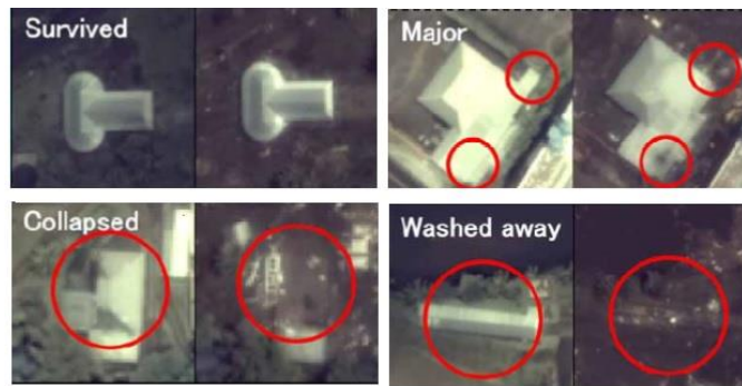
Figura 2.7: Niveles de daño por teledetección.
