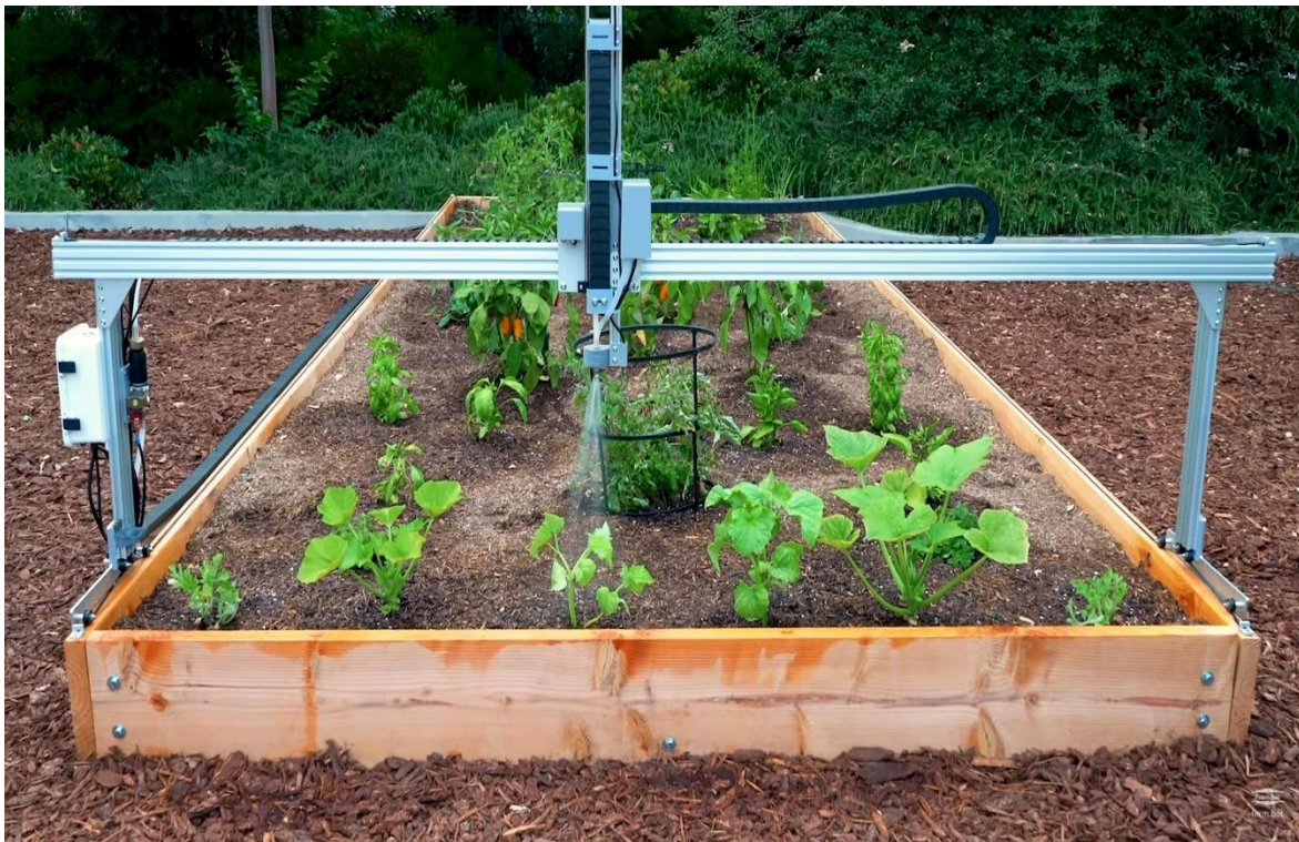
Figura 12: Riego de sistema Farmbot (Juan Antonio Pascual Estapé et al., 2020)
