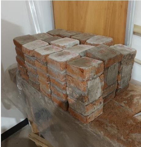
Figura 6. Set de prismas listos para ensayos destructivos.
