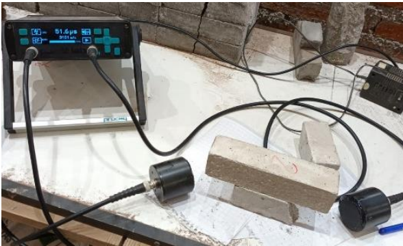
Figura 4. Instrumento Pundit Lab junto con sus transductores.
