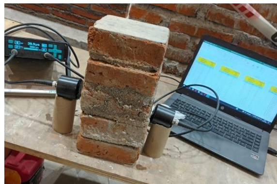
Figura 9. Prisma sometido a mediciones transversales.
