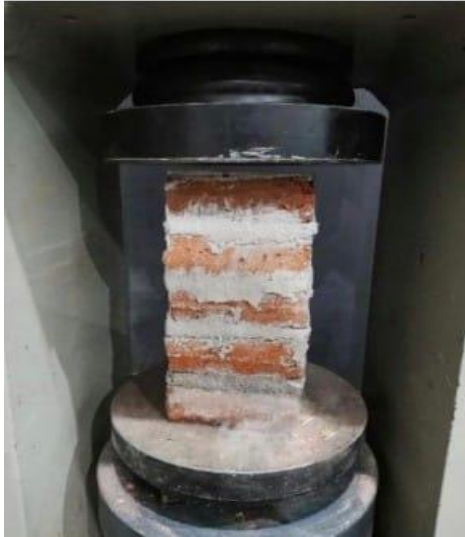
Figura 10. Prisma de albañilería antes del ensayo de compresión.
