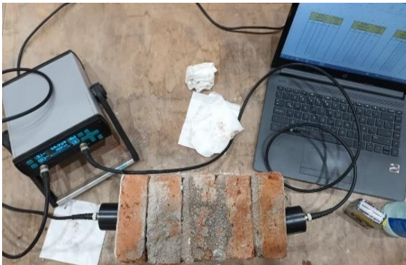
Figura 8. Prismas sometidos a mediciones longitudinales.
