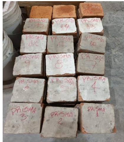
Figura 7. Vista en planta set de prismas de albañilería.
