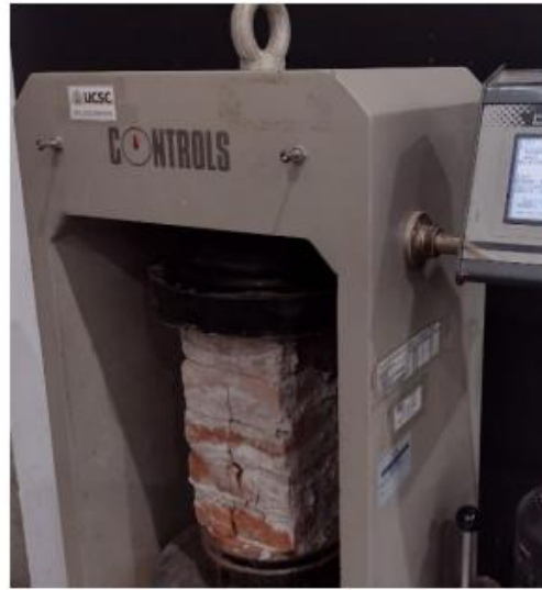
Figura 11. Prisma de albañilería después del ensayo de compresión.
