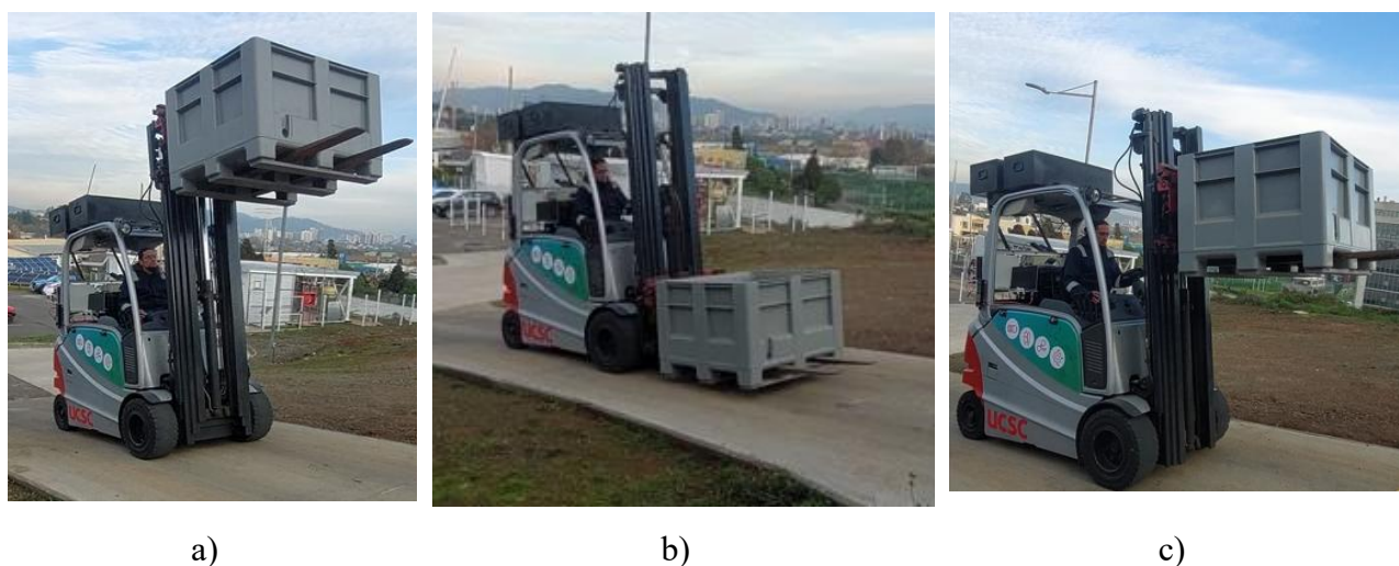
Fig. 7.2 Movimientos realizados en pendiente, (a) levante, (b) tracción, (c) levante y tracción
