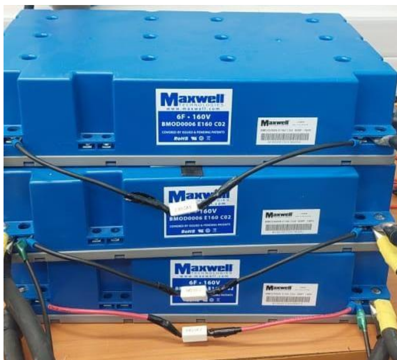
Fig. 3.3 Supercapacitores Maxwell conectados en paralelo.
