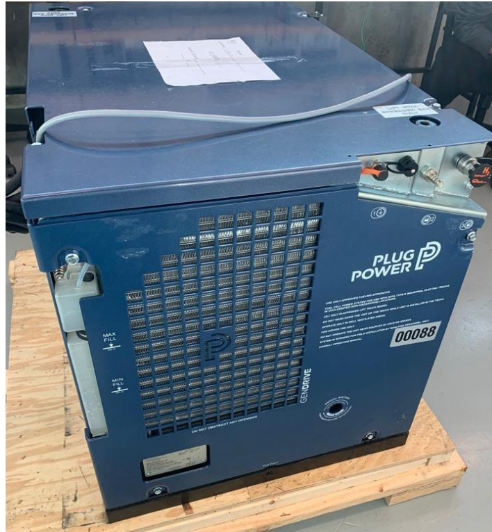
Fig. 3.2 Celda de combustible.
