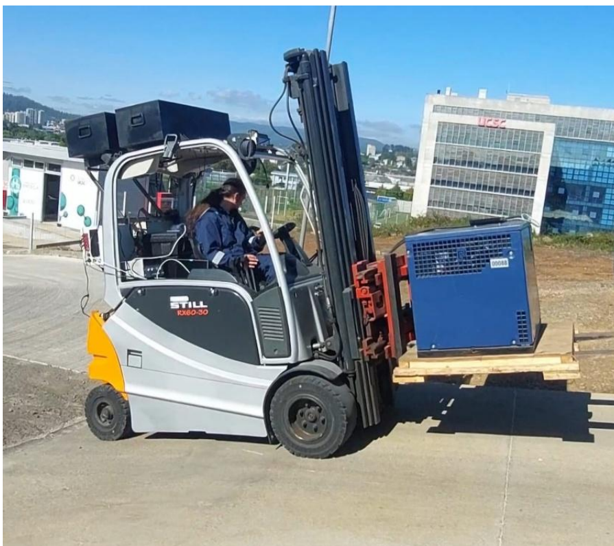
Fig. 6.1 Grúa horquilla ascendiendo un pendiente.
