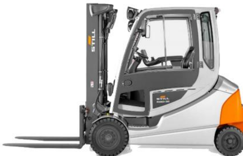
Fig. 2.1 Grúa horquilla Still RX60-30L
