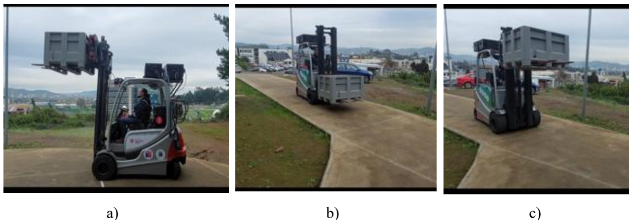
Fig. 7.1 Movimientos realizados terreno sin pendiente, (a) levante, (b) tracción, (c) levante y tracción
