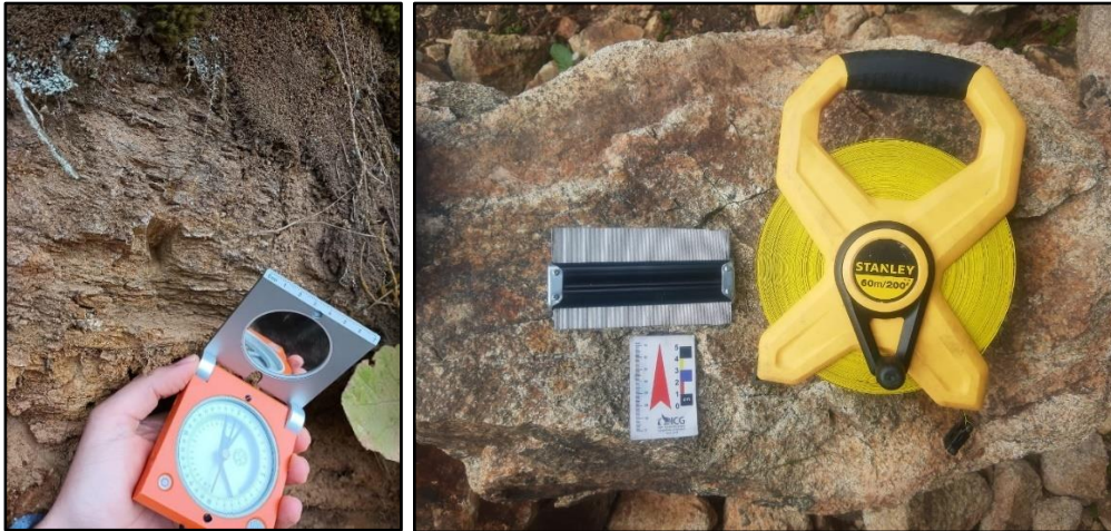
Figura 13: Materiales utilizados en investigación, brújula geomecánica, rugosímetro, cinta métrica y regla milimétrica.
