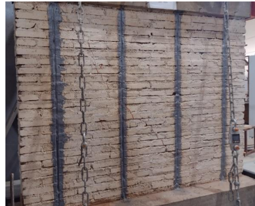
Figura 13: Grieta diagonal desde la esquina superior izquierda a la esquina inferior derecha del muro.
