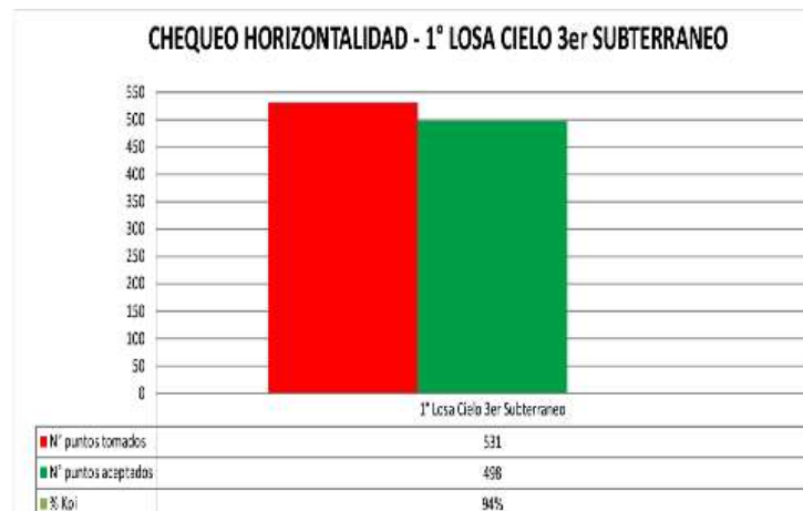
Figura 3: Análisis de resultados en losas (Informes control de obra gruesa edificio Caupolicán)
