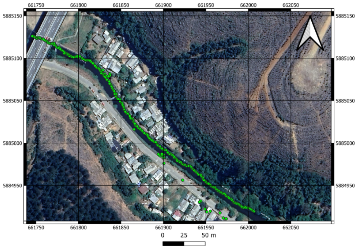
Figura 4. Puntos exportados de la pasada longitudinal con la ecosonda y proyectados en el software Qgis (Fuente: elaboración propia)
