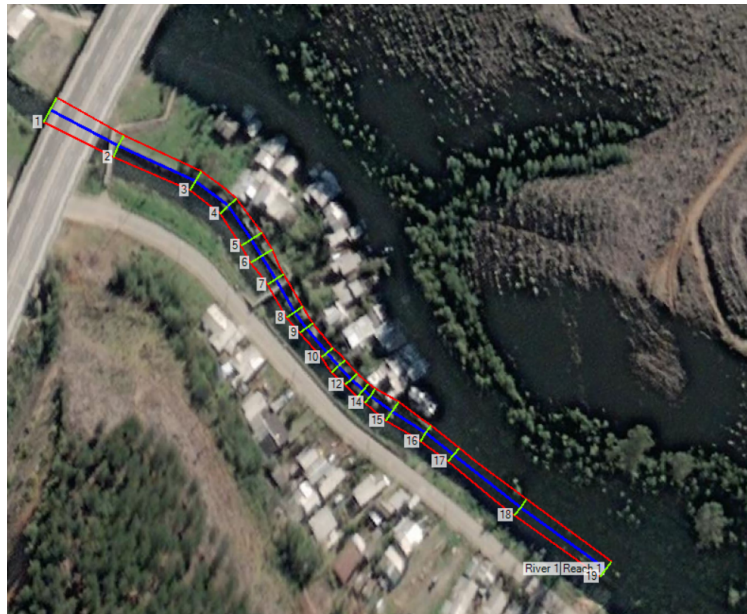
Figura 7. Geometría en software HEC RAS, obtenida a partir de las secciones transversales levantadas (Fuente: elaboración propia).
