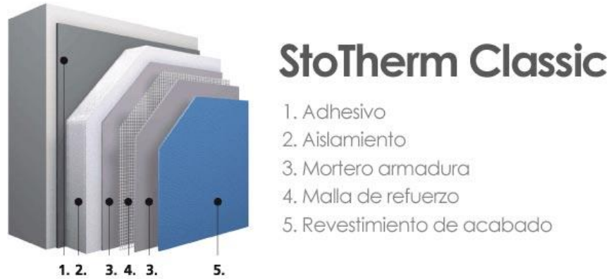
Figura 25: Esquema de revestimiento exterior solución STO.
