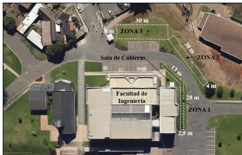
Figura 9: Zonas favorables para la instalación de las sondas geotérmicas. Basado en Google Earth.
