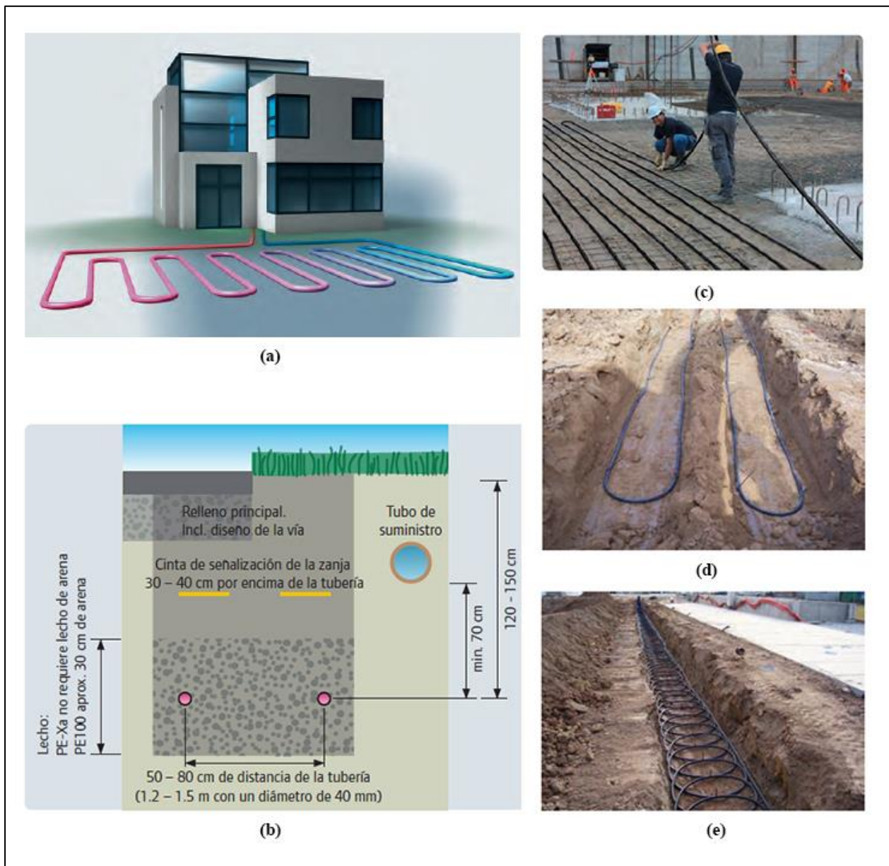
Figura 4: a) Ilustración esquemática de un sistema de captación horizontal (Uponor, 2013 p24), b) Perfil del lecho de captación horizontal según la norma VDI 4640 (Uponor, 2013 p30), c) Instalación de colectores horizontales (Uponor, 2013 p25), d) Intercambiador horizontal de lazo simple (IDAE, 2012 p27), e) Intercambiador horizontal en bucles de tipología “Slinky” (IDAE, 2012 p28).
