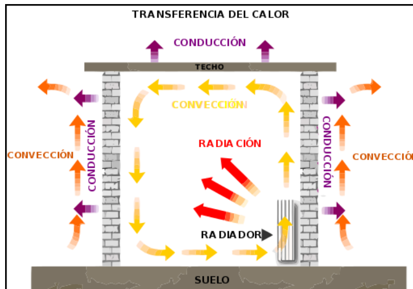
Figura 1: Ejemplo de los medios de propagación del calor dentro de una vivienda calefaccionada por un radiador. El fluido caliente dentro del radiador calienta por conducción las paredes de este. Una parte de la energía se emite por radiación si la temperatura superficial supera los 70^{\circ}\text{C} . El aire alrededor del radiador se calienta por convección disminuyendo su densidad y al pesar menos que el aire, fluye hacia arriba. Parte del calor escapa a mediante conducción a través de las paredes y techo de la vivienda. Una vez que el aire
